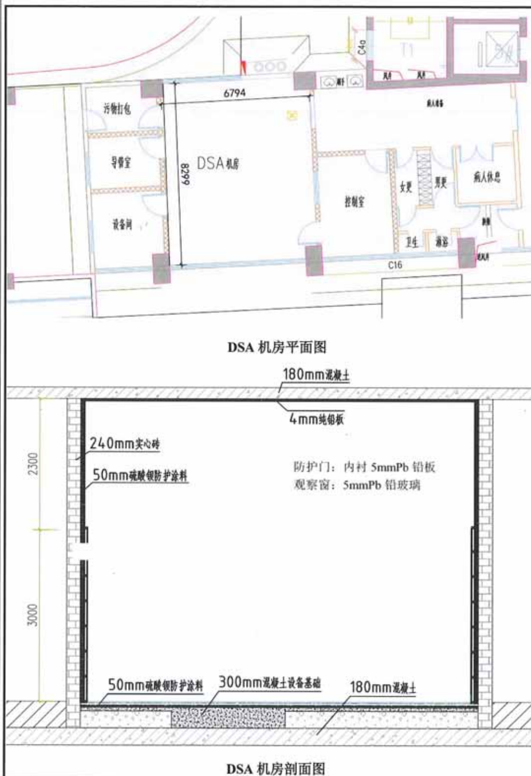
图 10-2 DSA 手术室屏蔽设计图
